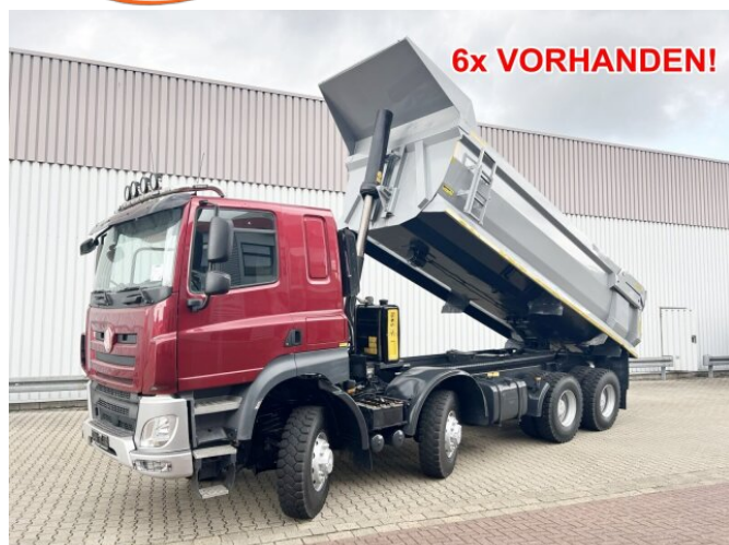
Tatra Phoenix 8x8, Stahmulde ca. 22m³, hydr. Heckklappe
