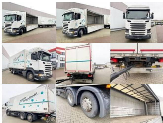
Scania R450 LB 6x2-4 Getränkekofter, Retarder, Lift-/Lenkachse, Stapleraufnahme
