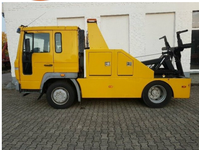
Volvo FL 612 L, Abschleppwagen Hubbrille 3 to
