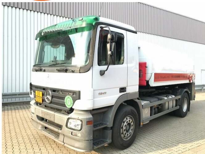
Mercedes-Benz Actros 1841 L 4x2, Esterer Tankaufbau ca. 13.500l, 2 Kammern
