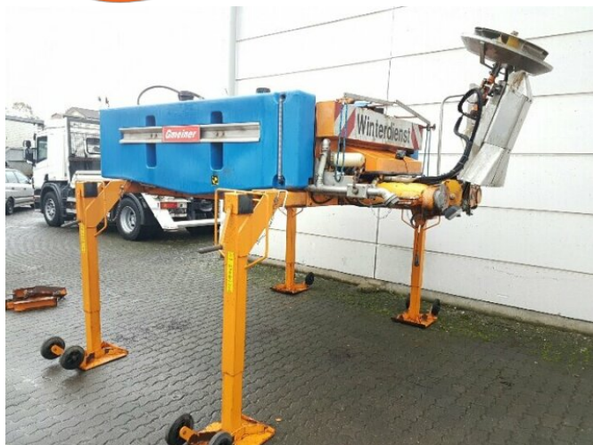
GMEINER Gmeiner Streuautomat STA 1800 TC mit Hydraulikantrieb
