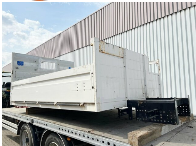
- Pritschenaufbau mit Platz für Heckkran
