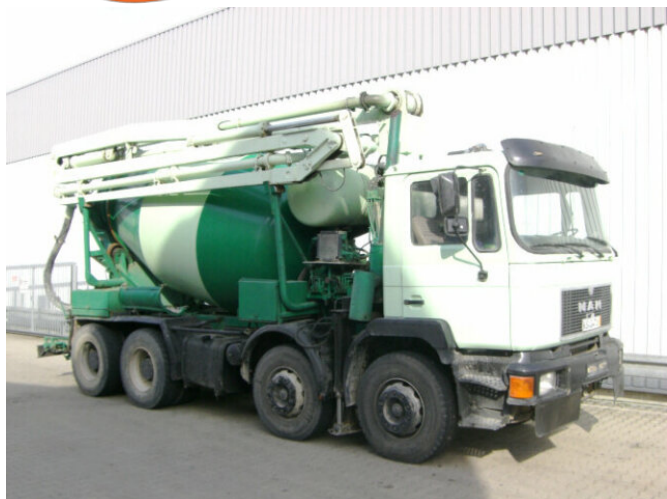
MAN 33.292 8x4 Mischer Stetter 7m 3 mit Pumpe Schwing 21m, 6-Zylinder
