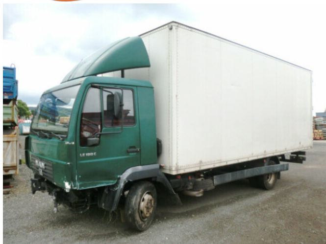
MAN L33 8.180 C 4x2, Unfallfahrzeug mit Frontalschaden
