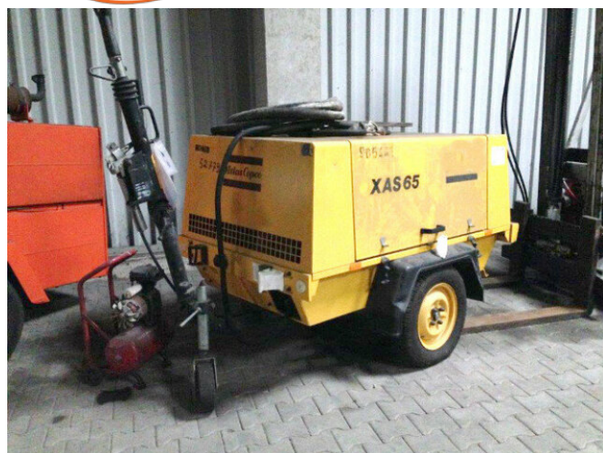
Atlas Copco ATLAS COPCO GA-XAS 65E, Kompressor 5m 3 /min, E-Antrieb
